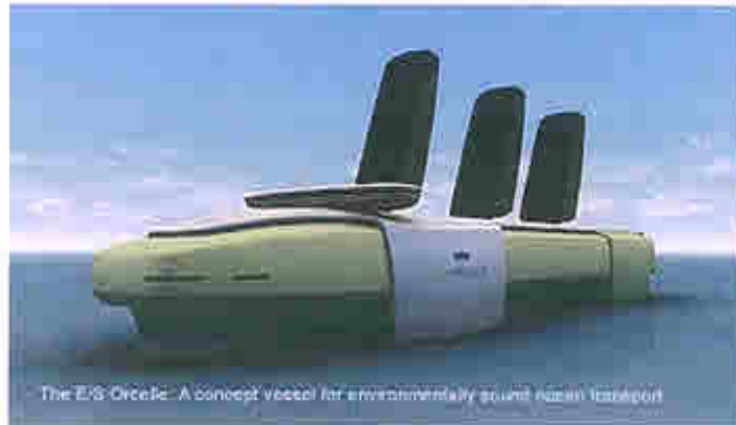
Figur: Konceptfartyget E/S Orcello som drivs med vind-, våg- och solenergi. Ett fartyg för emissionsfri, interkontinental fordonstransport. Källa: Wallenius Marine.
