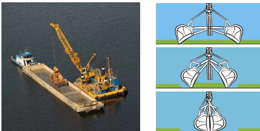
Figur 14. Gripskopeverk som lastar en pråm. Principskiss av miljöskopa till höger.
