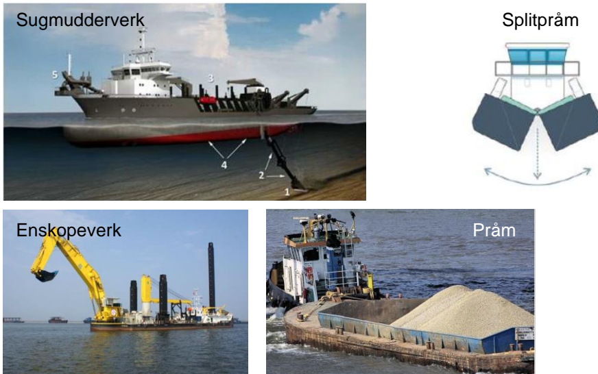
Figur 11: Metoder av muddring och dumpning. Bilder från Boskalis och (Becker, 2015)
